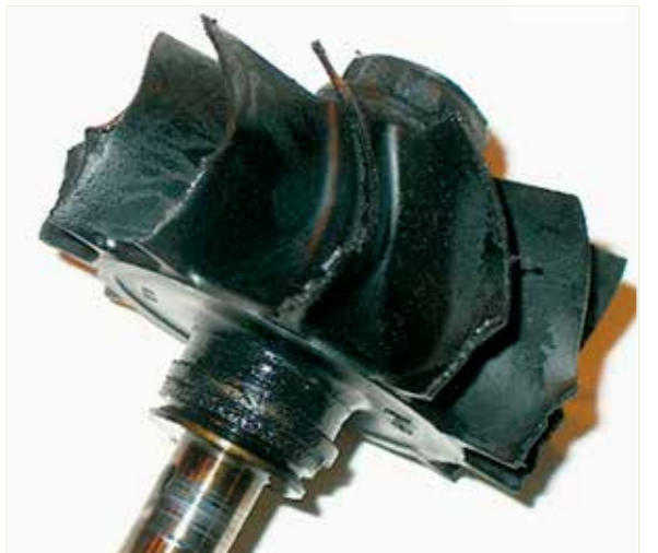
RUEDA DE LA TURBINA: DAÑOS EN LOS ÁLABES Daños por material extraño proveniente del motor o del múltiple de escape
