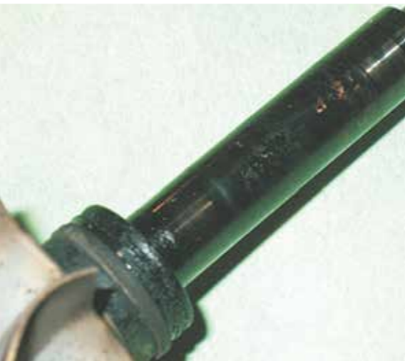
EJE: BARNIZ La formación de barniz en el eje es consecuencia de operación en temperatura excesiva tanto del turbo cuanto del aceite lubricante
