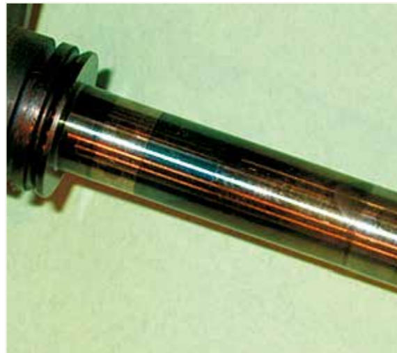
EJE: DECOLORACIÓN Eje con decoloración por sobrecalentamiento con mala lubricación. Los puntos en negro en la región de los bujes evidencian parada caliente
