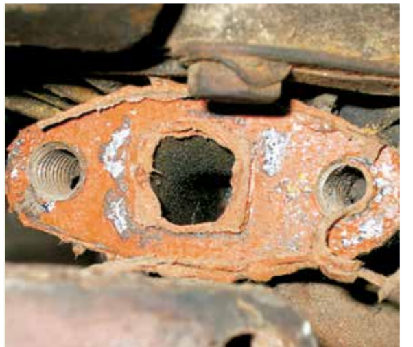
CARCASA CENTRAL: OBSTRUCCIÓN POR SILICONA La utilización de silicona o adhesivos en la entrada y salida de aceite cierran el agujero y disminuyen el caudal de aceite haciéndolo calentarse demasiado
