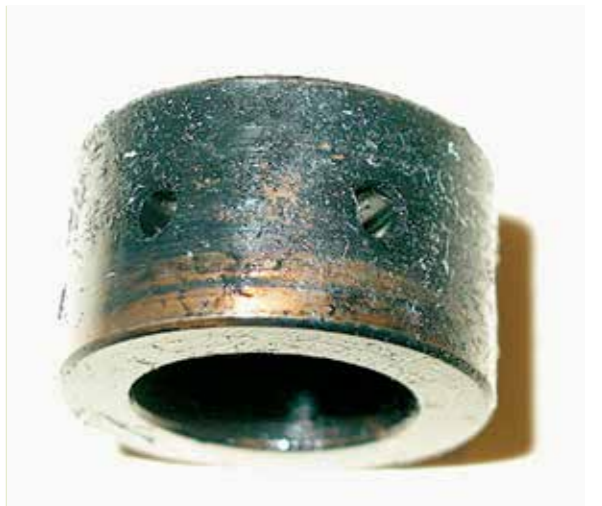
COJINETE: AGREGACIÓN DE MATERIAL Aceite de mala calidad o contaminados con combustible impregnan las superficies del cojinete por efecto del calor que sufren
