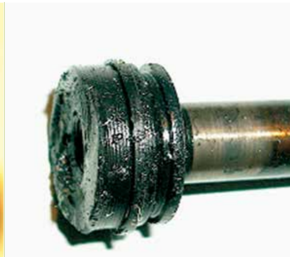
EJE: ROTURA Eje con rotura en el cambio de sección o en la región de soldadura por desgaste excesivo de los bujes, desbalanceo o parada brusca del mismo
