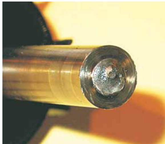
EJE: ROTURA Eje con rotura en el cambio de sección o en la región de soldadura por desgaste excesivo de los bujes, desbalanceo o parada brusca del mismo
