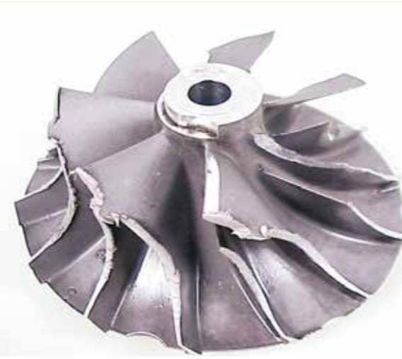
RUEDA COMPRESORA: ROTURA DEL ÁLABE Rotura del álabe de la rueda compresora por sobregiro del eje por filtro de aire obstruido o rotura de tubería entre turbo y admisión del motor
