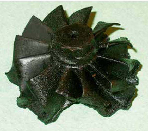
RUEDA DE LA TURBINA: ROTURA Rotura de la rueda de la turbina por operación intensiva en aceleración y deceleración o sobregiro del eje
