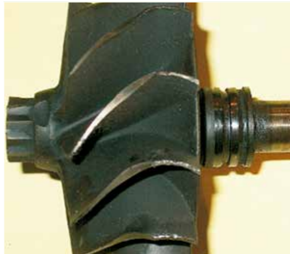
RUEDA DE LA TURBINA: DEPÓSITOS DE CARBÓN Y PASO DE ACEITE Depósitos de carbón en la región del aro de pistón o en los álaves indican pérdida de contrapresión en el escape o desgaste excesivo de los bujes
