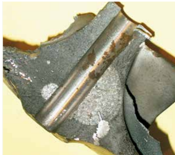
RUEDA COMPRESORA: ROTURA AL MEDIO Rotura al medio de la rueda compresora por operación en altura, por sobregiro del eje, por filtro de aire obstruido o rotura de tubería entre turbo y admisión del motor
