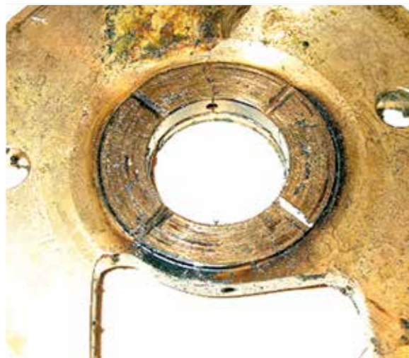
COJINETE AXIAL: RAYAS Cojinete y arandela de desgaste con rayas por contaminación o mala lubricación
