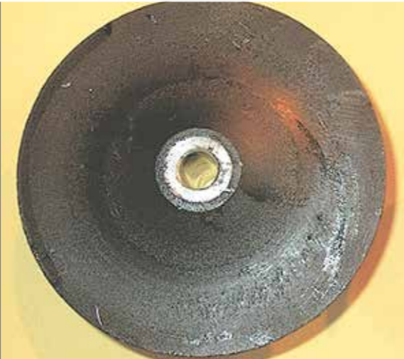
RUEDA COMPRESORA: DEPÓSITO DE CARBÓN Rueda compresora con paso de aceite por el aro de pistón, por regreso de aceite obstruido, sobrepresión del cárter o desgaste excesivo de los bujes
