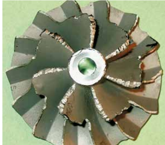
RUEDA COMPRESORA: DAÑO POR CONTACTO Raspado severo en la rueda compresora causada por objeto extraño
