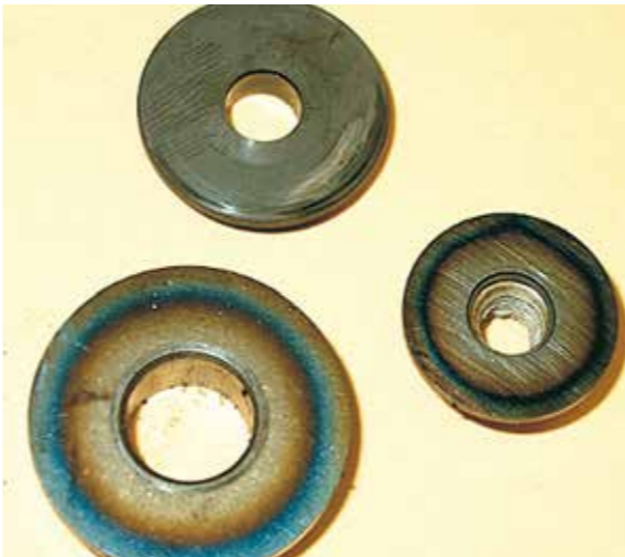
CARCASA CENTRAL: DECOLORACIÓN Decoloración por sobrecalentamiento excesivo
