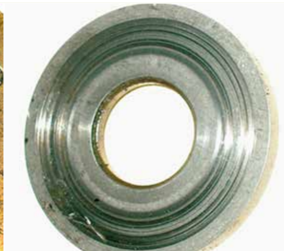
COJINETE AXIAL: RAYAS Cojinete y arandela de desgaste con rayas por contaminación o mala lubricación
