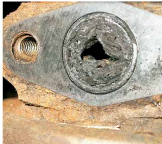
CARCASA CENTRAL: SALIDA DE ACEITE OBSTRUIDA POR CARBÓN Excesiva contrapresión del cárter o fuga de gases por los aros de pistón del motor hacen el aceite calentarse formando depósitos disminuyendo el caudal de aceite
