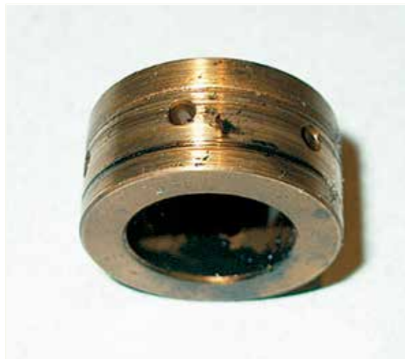
COJINETE: DESGASTE Y RAYAS Rayas en los cojinetes debido a aceite contaminado con partículas abrasivas
